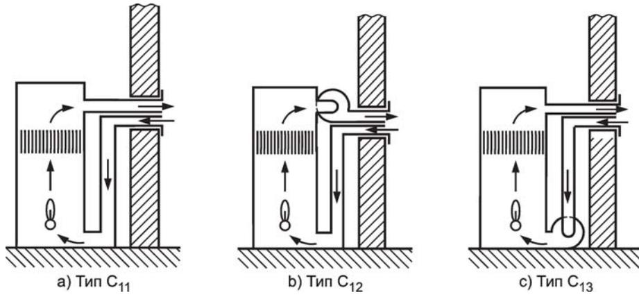
Рисунок В.1 — Водонагреватели типа С<sub>1</sub>
