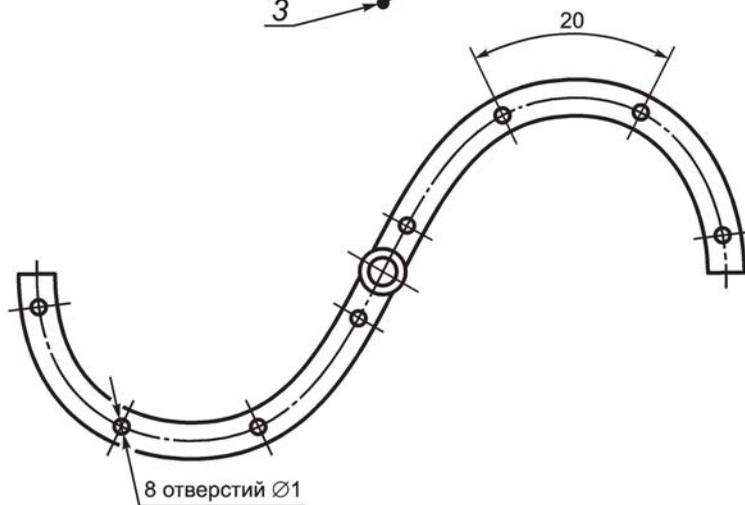
1 — медная трубка Ø 6 мм; 2 — медная трубка Ø 4,3 мм; 3 — термопара
