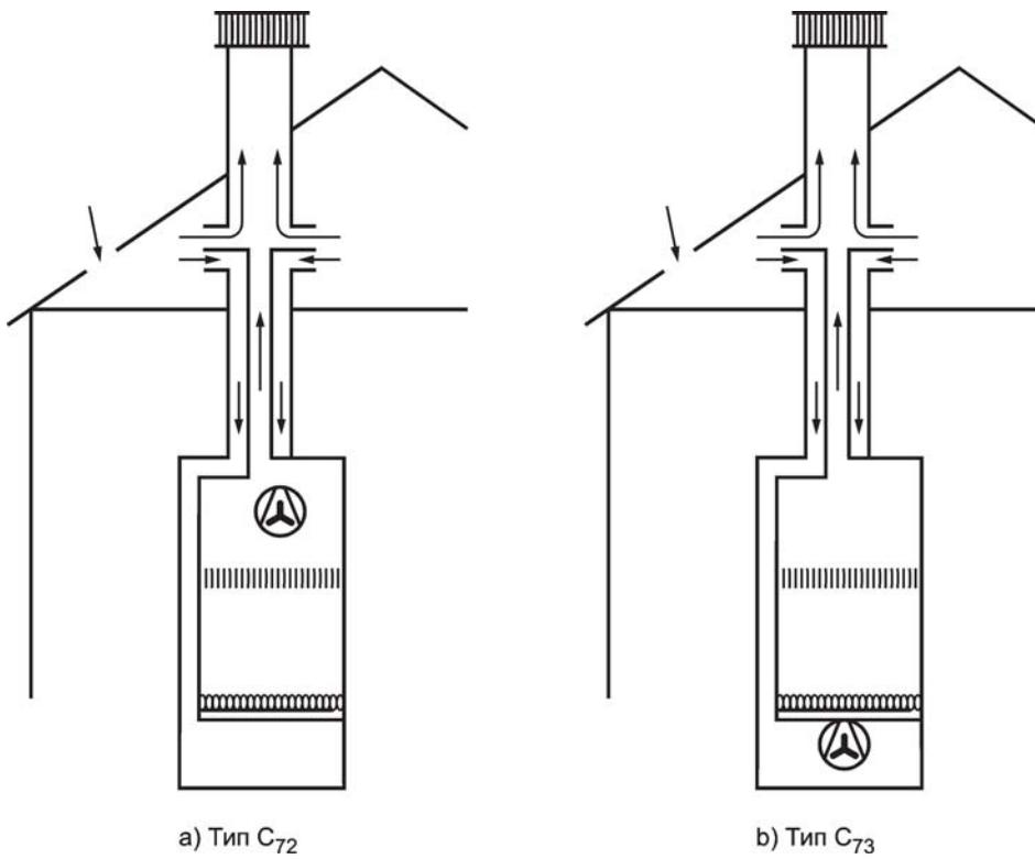
Рисунок В.7 — Водонагреватели типа C<sub>7</sub>
