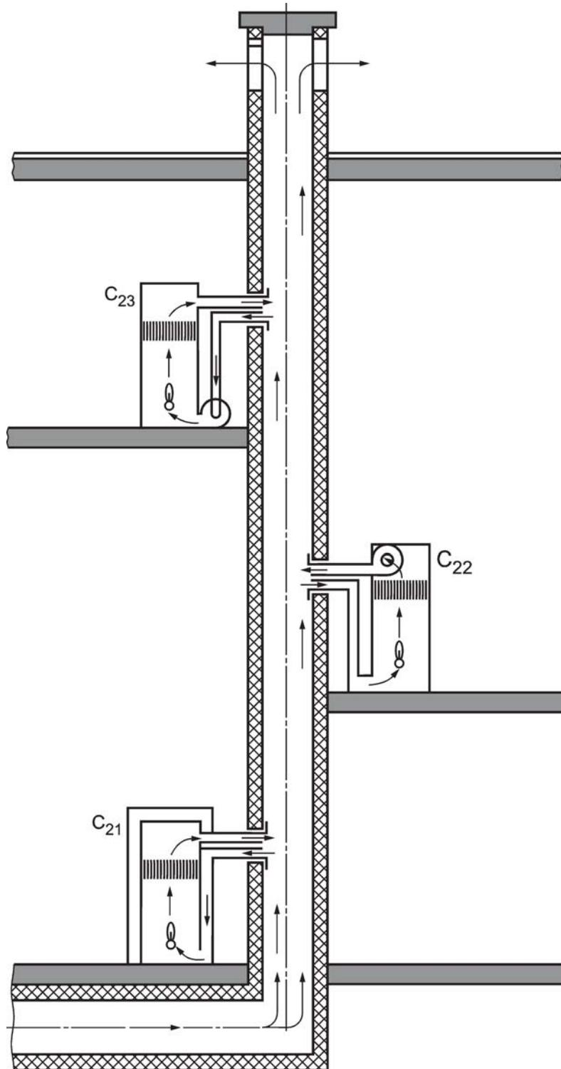
Рисунок В.2 — Водонагреватели типа C<sub>2</sub>
