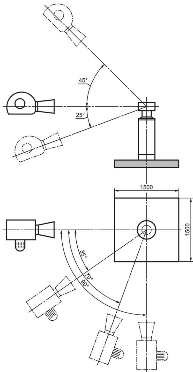
Рисунок С.3 — Установка для испытания водонагревателей типов С<sub>3</sub>, В<sub>4</sub> и В<sub>5</sub> с вертикальным терминалом, установленным на горизонтальной стене
