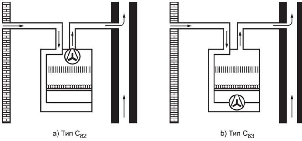
Рисунок В.8 — Водонагреватели типа C<sub>8</sub>
