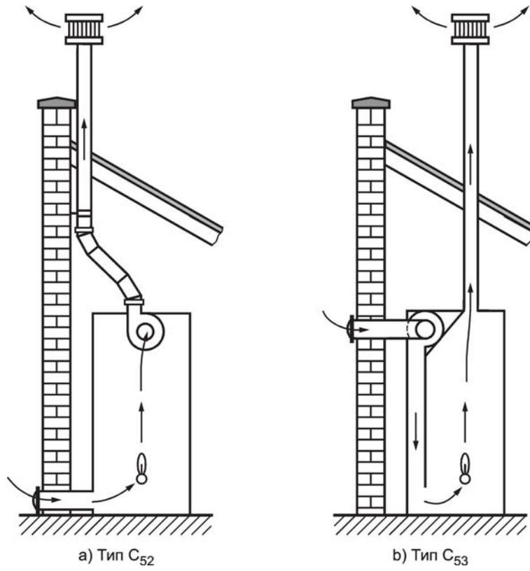
Рисунок В.5 — Водонагреватели типа C<sub>5</sub>
