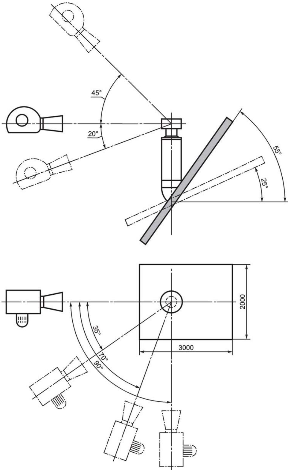
Рисунок С.4 — Установка для испытания водонагревателей типов С<sub>3</sub>, В<sub>4</sub> и В<sub>5</sub> с вертикальным терминалом, установленным на наклонной стене
