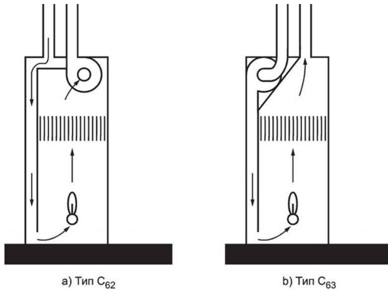
Рисунок В.6 — Водонагреватели типа C<sub>6</sub>
