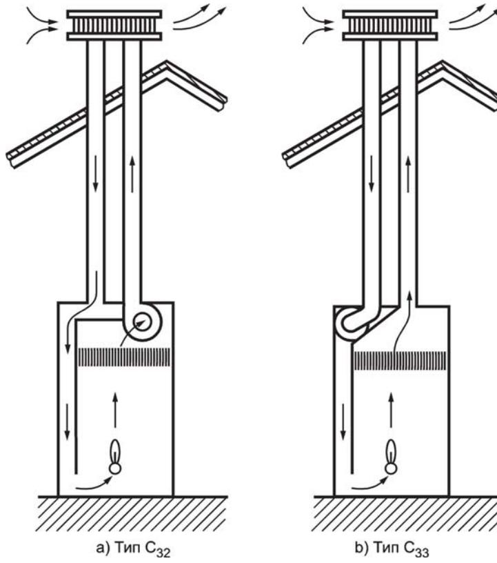
Рисунок В.3 — Водонагреватели типа C<sub>3</sub>
