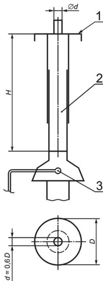
1 — пластина; 2 — телескопический испытательный дымоход; 3 — детектор
