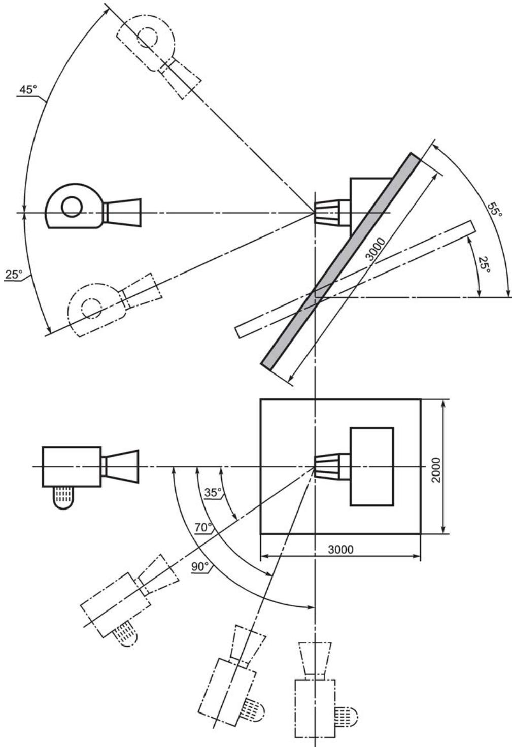
Рисунок С.2 — Установка для испытания водонагревателей типов С<sub>1</sub>, В<sub>4</sub> и В<sub>5</sub> с горизонтальным терминалом, установленным на наклонной стене
